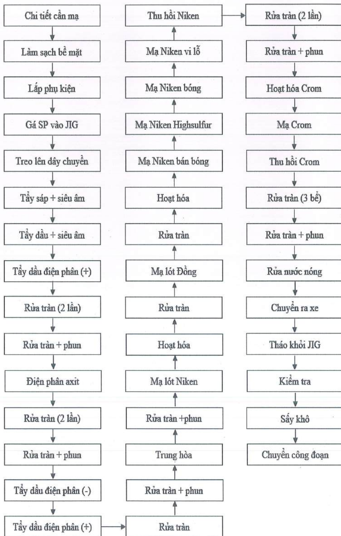
Hình 7: Quy trình mạ line 2
