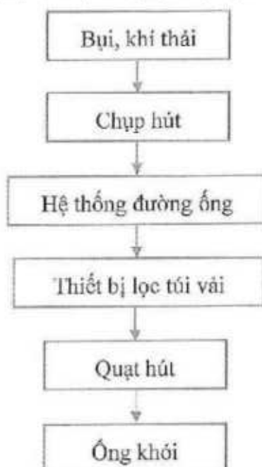
Hình 4.9. Công nghệ xử lý bụi gỗ tại xưởng 1
