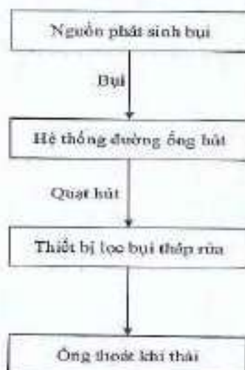
Hình 18 Sơ đồ khối công nghệ hệ thống hút và xử lý bụi tháp rửa
