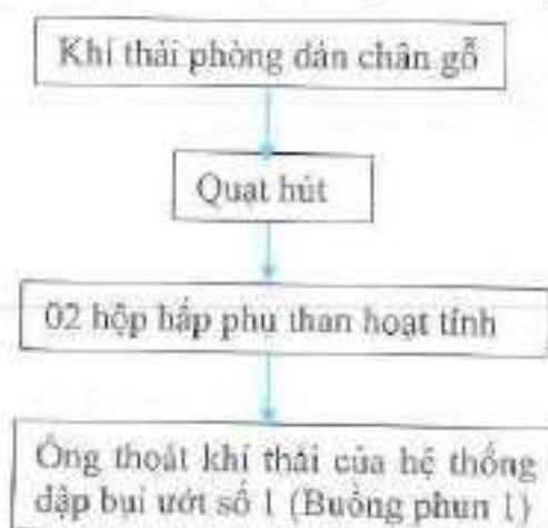
Hình 31 Sơ đồ công nghệ xử lý khí thải hơi dung môi bằng than hoạt tính
